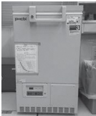
ワクチン保管冷凍庫
