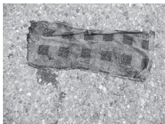
ポンプ場の故障の原因 となったタオル
