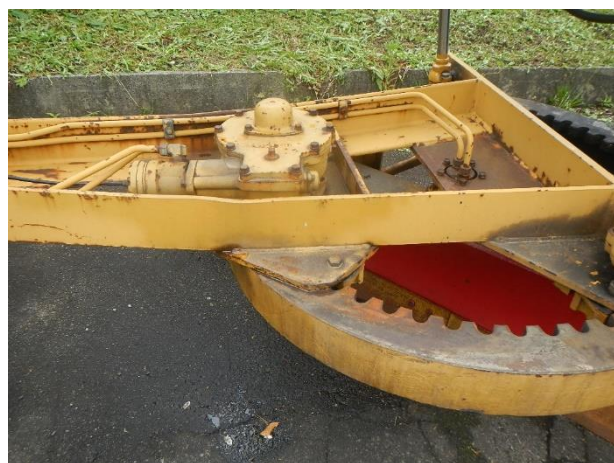
【サークル部分オイル漏れ】
